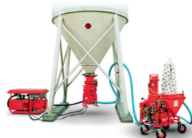
silo + ometací stroj + kompresor
