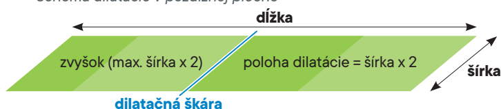
Schéma dilatácie v pozdĺžnej ploche
