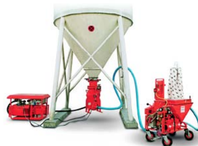
silo + omietací stroj + kompresor
