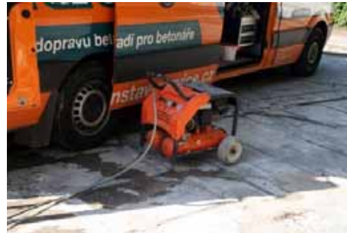
Obrázek 4: Kompresor pro stlačený vzduch
