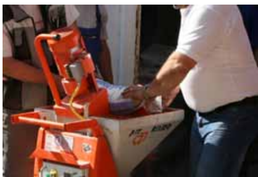
Obrázek 9: Vsyávání suché maltové směsi do zásobníku
