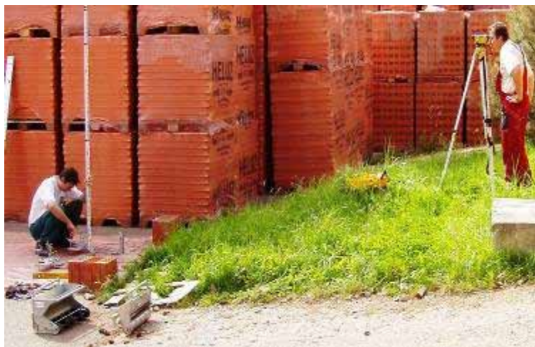
Výškové zaměření nejvyššího bodu pomocí nivelačního přístroje a latě
